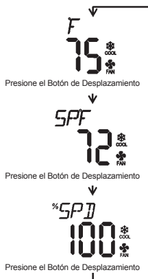
Secuencia del Botón de Desplazamiento, Modo de Enfriamiento de Control de Temperatura, Temperatura y Pantalla en °F en funcionamiento.
