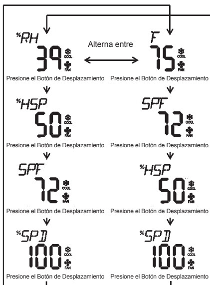
Secuencia del Botón de Desplazamiento, Modo de Enfriamiento de Control de Temperatura y Humedad, Temperatura y Pantalla en °F en funcionamiento.
